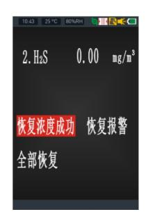
当设置错误或测试浓度不准确时需要进行恢复出厂的操作,如果是人为因素造成的不良可以得到恢复,可以恢复出厂的参数:零点校准值、浓度校准值、报警 值、报警方式、报警模式、最大量程。
