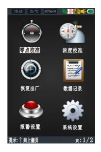
按 "ENTER"键进入零点校准界面,通过" ◀"键和" ▶"键选择要校准的通道,按 "ENTER"键进行零点校准,如下图:
