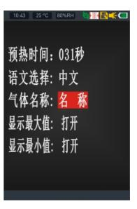
**显示最大值**:选择打开就在单通道界面显示本次测量的最大值和上次测量的最大值,如右图:
