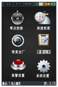
按 "ENTER" 键进入数据记录界面:如图:按 "ENTER"键选择要查询记录的通道,通过"◀"键和"▶"键选择到"开始时间",按 "ENTER"键进入设置查询起始时间,如下图:
