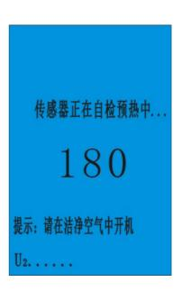
倒计时完以后进入测试界面,按 "ENTER 键"可切换不同的显示模式,按 "◀"键和 "▶"键切换通道,如下图:
