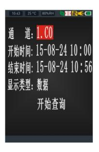
通过"◀"键和"▶"键选择到"结束时间",按"ENTER"键设置查询结束时间,选择"开始查询",按"ENTER"键查询,如右图及下图:
