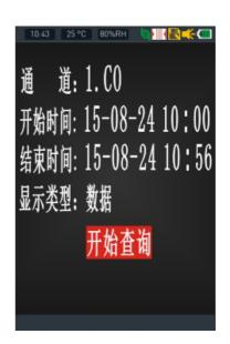
如果没有查询到记录,说明了数据存储功能没有开启需要在"系统设置"→"存储设置"里开启存储功能。选择"定时存储"即实时存储功能并设置存储周期(时间间隔),如下图:
