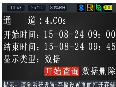
如果没有查询到记录，说明了数据存储功能没有开启需要在“系统设置”→“存储设置”里开启存储功能。选择“定时存储”即实时存储功能并设置存储周期（时间间隔），如下图：
