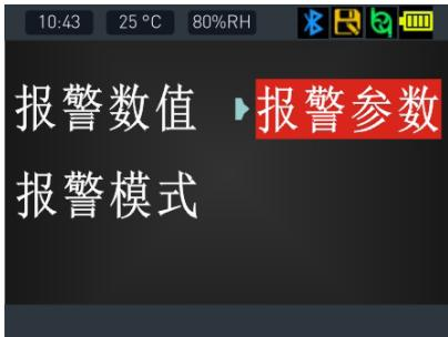
**报警方式**: 可选声光、振动、声光+振动、无报警按“■”键选择,
