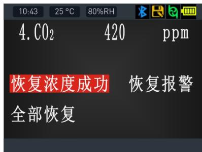
当设置错误或测试浓度不准确时需要进行恢复出厂的操作，如果是人为因素造成的不良可以得到恢复，零点校准值、浓度校准值、报警值、报警方式、报警模式、最大量程。
