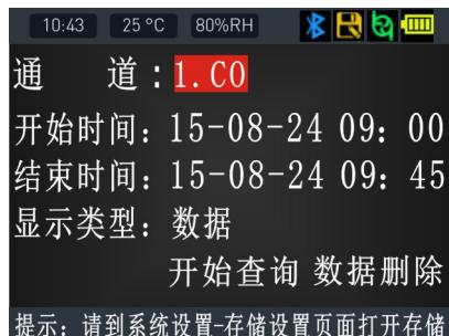
通过“◀”键和“▶”键选择到“开始时间”，按“■”键进入设置查询起始时间。通过“◀”键和“▶”键选择到“结束时间”，按“■”键设置查询结束时间，如下图：
