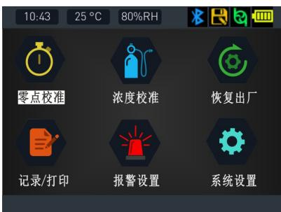
按“■”键进入零点校准界面，通过“◀”键和“▶”键选择要校准的通道，按“■”键进行零点校准，如下图：
