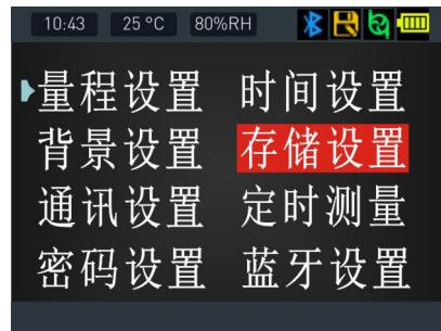
**存储方式:** 可设置定时存储、报警触发两种模式 “定时存储” 是在每个存储周期时间内存储数据一次, 如右图:
