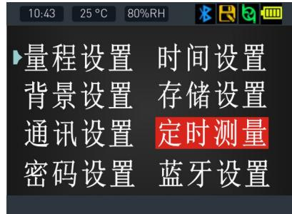
默认的测量时间是0秒，如果不修改这个数值，此功能不起作用，当修改为一定的数值，此功能开始起作用，若要使用定时测量的功能。一般情况需要把数值修改为30到60秒，按一下泵的开关“PUMP”键开始测量，达到设定的时间就停止测量。定时测量的界面：显示屏顶部显示设定的时间和剩余时间，
