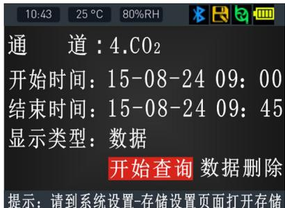
如果没有查询到记录，说明了数据存储功能没有开启需要在“系统设置”→“存储设置”里开启存储功能。选择“定时存储”即实时存储功能并设置存储周期（时间间隔），如右图：
