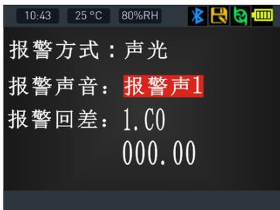
**报警回差：**即报警回程差，可设置每一通道的报警回差值，如果设置为0，只要数值达到报警设定值就马上报警，若不想数值在报警设定值的临界点发生频繁报警，可以把报警回差设置一定的数值按“■”键可以切换要修改的通道按“▶”键可以修改数值，如右图：
