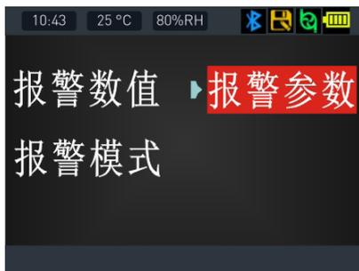
**报警方式：**可选声光、振动、声光+振动、无报警按“■”键选择，如右图：
