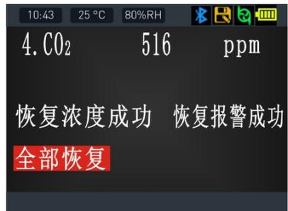
当设置错误或测试浓度不准确时需要进行恢复出厂的操作，如果是人为因素造成的不良可以得到恢复，可以恢复出厂的参数：零点校准值、浓度校准值、报警值、报警方式、报警模式、最大量程。
