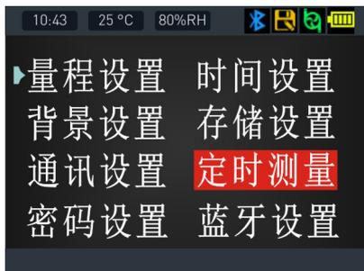
默认的测量时间是0秒，如果不修改这个数值，此功能不起作用，当修改为一定的数值，此功能开始起作用，若要使用定时测量的功能。一般情况需要把数值修改为30到60秒，按一下泵的开关“PUMP”键开始测量，达到设定的时间就停止测量。定时测量的界面:显示屏底部显示设定的时间和剩余时间，
