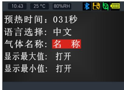
**显示最大值：**选择打开就在单通道界面显示本次测量的最大值和上次测量的最大值，如右图：
