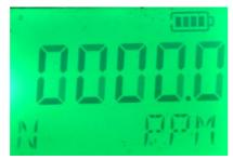
如果确认要校准目标点,在目标点设置菜单通过K3 键修改为"Y";按 K1键确认进行目标点校准,如果校准成功,左下角出现"YES"字样,并且数值变为在菜单"CER"里设置好的值;如果校准不成功,左下角出现"NO"字样。如右图及下图:
