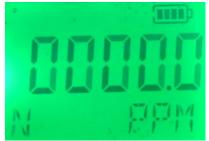
如果确认要校准零点,在零点设置菜单通过,↓ 键修改为 "Y";按 K1键确认进行零点校准,如果校准成功,左下角出现 "YES"字样;如果校准不成功,左下角出现 "NO"字样。如右图及下图:
